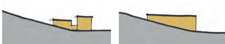
Implantation à la rupture de pente
